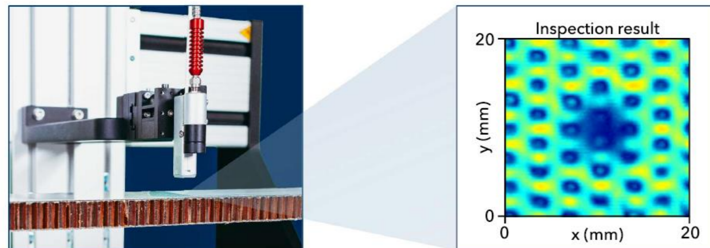
Delamination in einer Wabenstruktur
