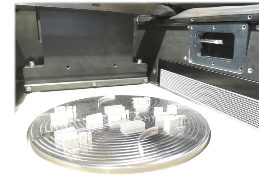
Mikrofon seitlich im Bauraum montiert
