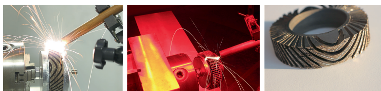
Bild 4: Beispiel einer komplexen Laserschweißanwendung für einen neuen Beschleunigungsring im CERN, der Europäischen Organisation für Kernforschung mit dem Scout 300 und einem 4-kW-Faserlaser mit 50 µm Faserdurchmesser von nLight
